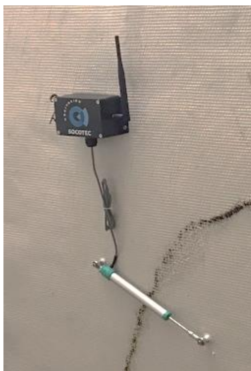
Figure 12 : Photo d'une installation de NodeLog avec un transducteur GEFRA de 100 mm
