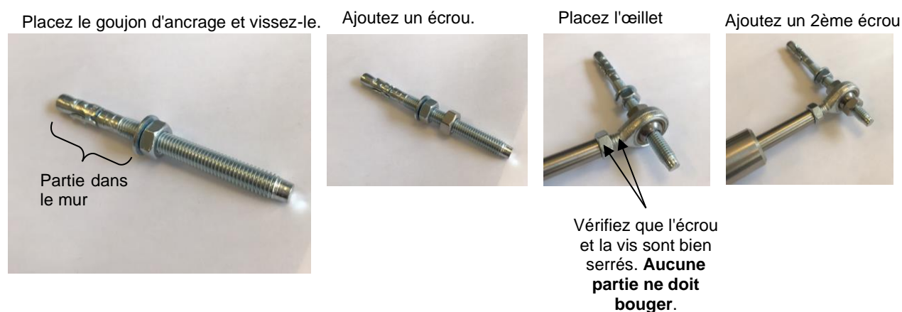
Figure 7 : Illustration du processus en 4 étapes pour installer un Fissuromètre Electrique
